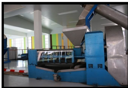
ภาพที่ ๕ : เครื่องบรรจุแบบปริมาตรและอัดแก๊สไนโตรเจน
