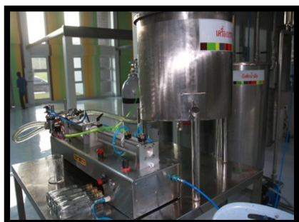
ภาพที่ ๔ : เครื่องสกัดน้ำมันปาล์มที่ปรับปรุงเพื่อใช้สกัดน้ำมันจากเมล็ดชา
