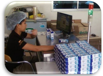
ภาพที่ ๑๐ : การใช้งานจริงของเครื่อง ในการคัดนมโรงเรียนที่ผิดปกติก่อนบรรจุลงลัง ทำงานวันละ ๗-๘ ชั่วโมง
