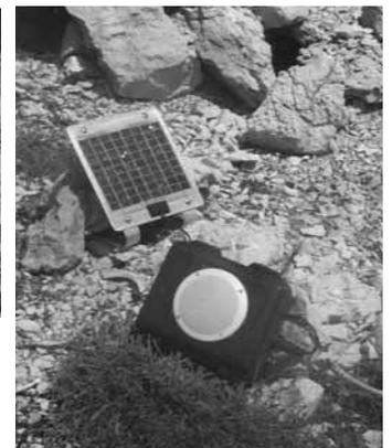
Système de diffusion de chant automatisé (haut-parleur et panneau solaire) installé devant un nichoir artificiel
