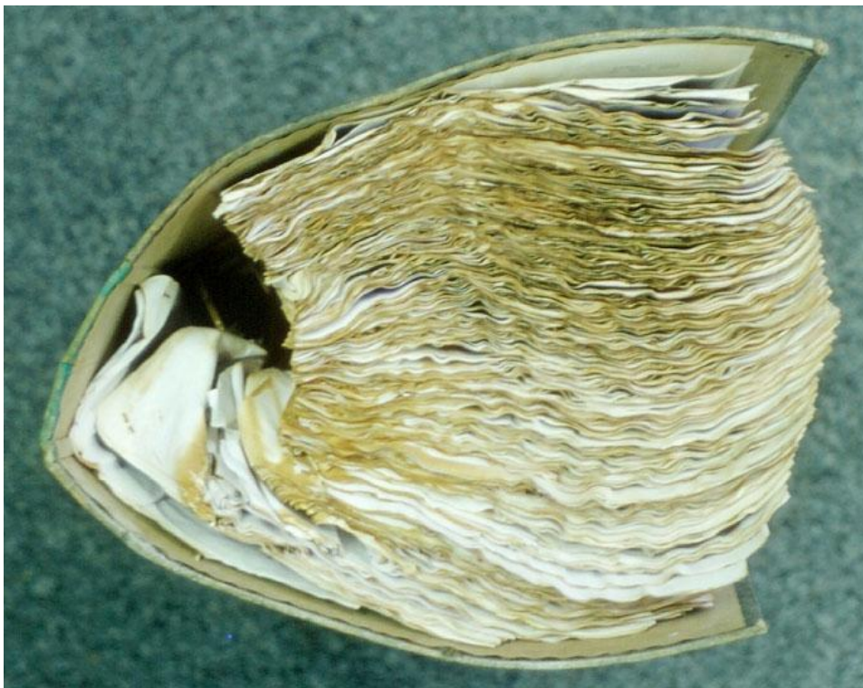
Hochwasser 2002 in Sachsen – Verwellungen Foto: Kunze
