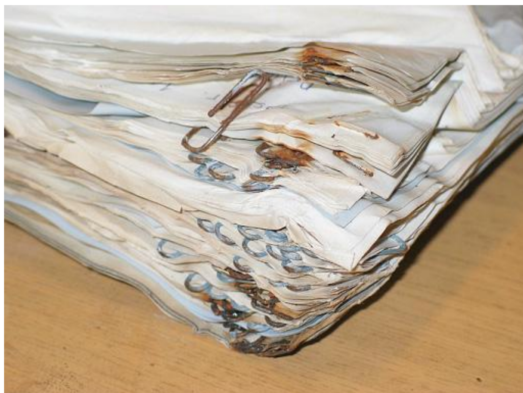
Hochwasser 2002 in Sachsen – Verformung und Rostbildung durch Büro- und Heftklammern Foto: Kunze
