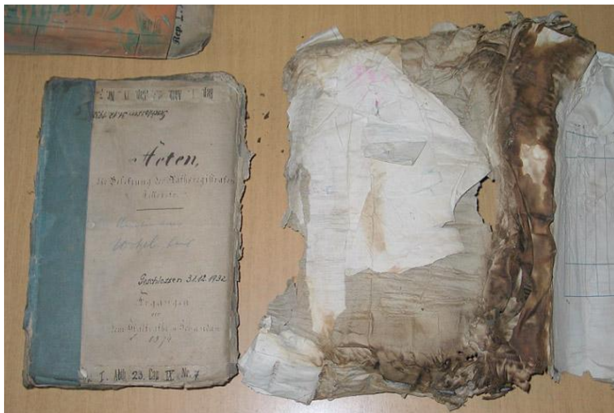
Hochwasser 2002 in Sachsen – Schutz durch Kartonierung, hier: nahezu unversehrte Akte mit stark geschädigtem Behälter Foto: Keimer
