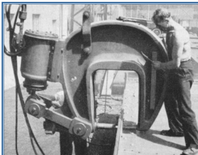
Szegecselő patkó (pneumatikus sajtó)
