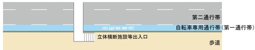
図 II-17 自転車専用通行帯の設計例
