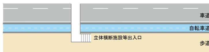
図II-13 車道空間を縮小して自転車道を設置、または新設道路に自転車道を設置する例
