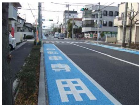
写真 II-1 街渠をエプロン幅の狭い平坦性の高いものに置き換えた事例
