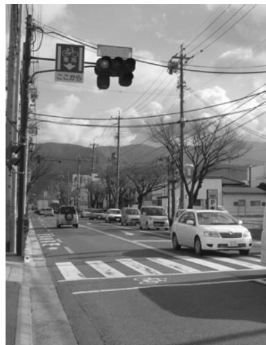
写真 II-6 道路標識「専用通行帯(327の4)」と道路標示「専用通行帯(109の6)」を設置した事例
