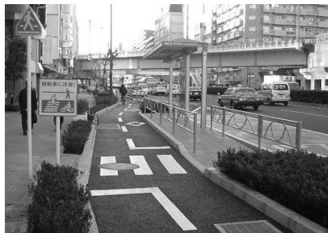
写真 II-17 交通島を設置し、道路標識及び道路標示を設置した事例
