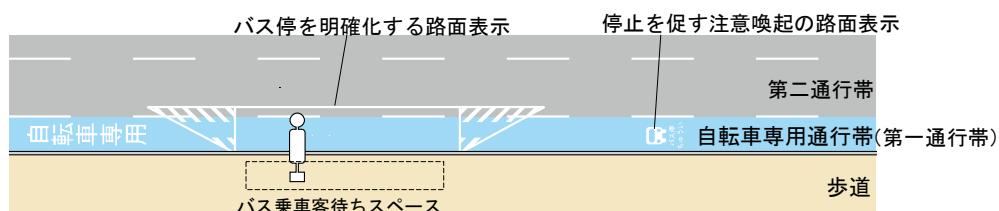
図 II-10 ストレート型バス停を設置する例
