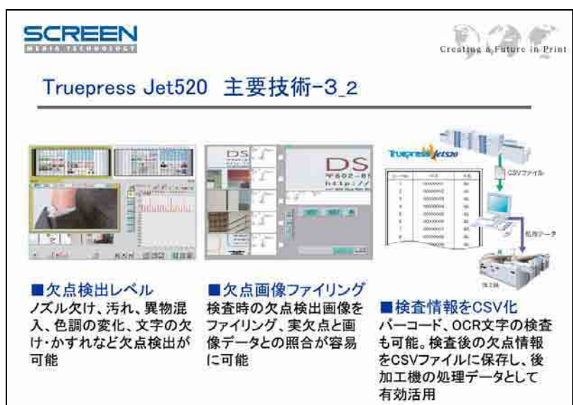
図 5-6-4 プリンタ内に搭載された検査装置
