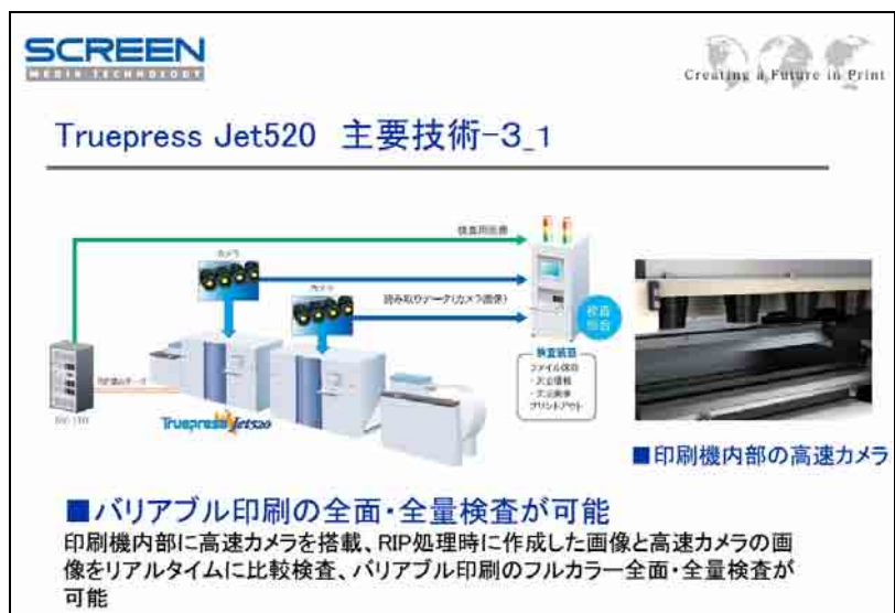
図 5-6-3 プリンタ内に搭載された検査装置
