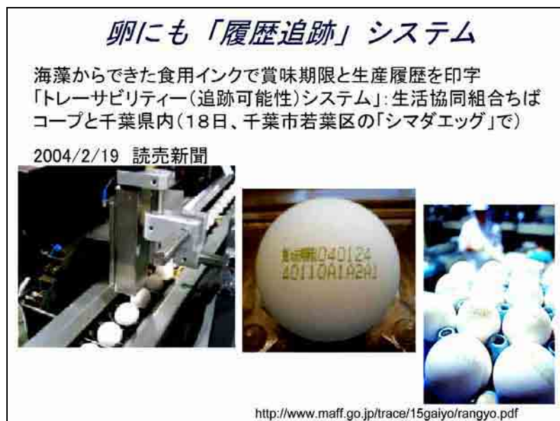
図 5-5-2 インクジェットによる卵表面への印字例
