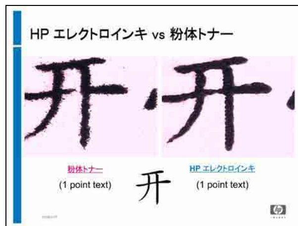
図 5-2-6 乾式・液体トナーによる 1 ポイントテキスト再現
