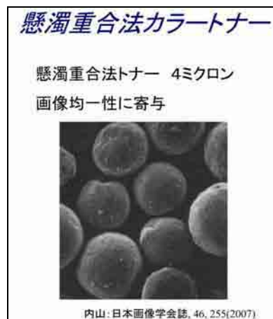
図 5-1-8 懸濁重合法により製造されたトナー粒子の顕微鏡写真
