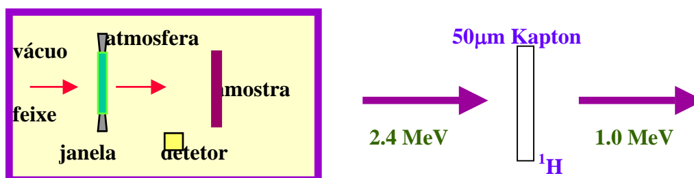
Figura 1 – Esquema do arranjo experimental de PIXE externo
