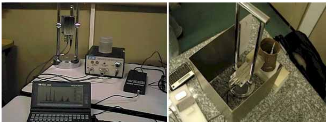
Figura 4 - Arranjo experimental de análise com EDXRF portátil
