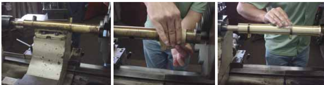
Figura 4 (a, b e c) - Imagens da remoção mecânica dos produtos de corrosão presentes na superfície do tubo de luneta.
