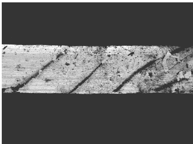
Fig. 6 – Lamina del hilo del traje del Cristo, Back-scattered Image 25X.
