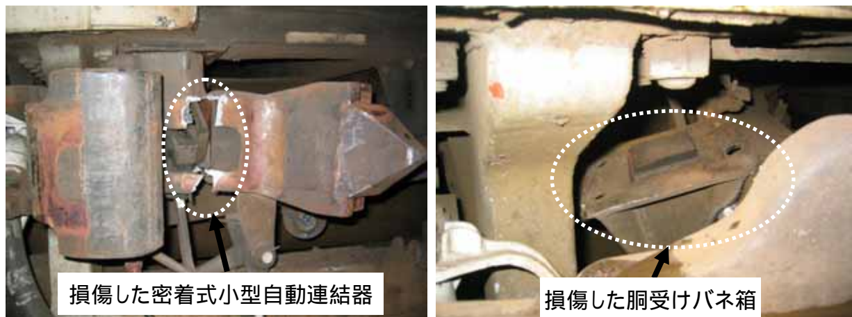
写真5 本件車両の損傷状況
