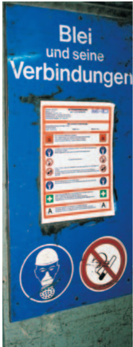
Bild 5-1: Aushang einer Betriebsanweisung über den Umgang mit bleihaltigen Gefahrstoffen
