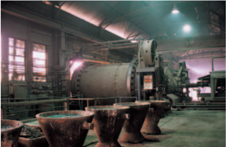
Bild 1-4: Erschmelzen von bleihaltigen Materialien im Drehofen
