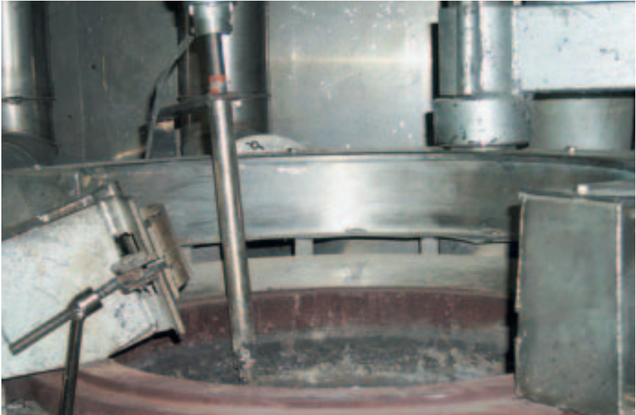
Bild 3-2: Bleischmelztiegel mit Ringabsaugung
