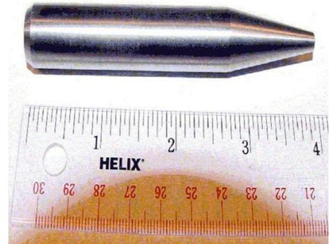
Abb. 1: Urankern eines panzerbrechenden DU-Geschosses Kaliber 30 mm
