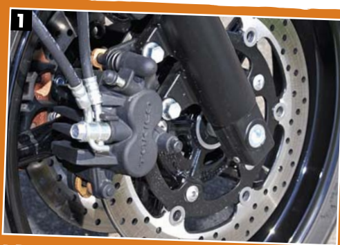
1. Przednie dwie tarcze o średnicy 290 mm nie gwarantują sukcesu. Hamulce są takie sobie. 2. Żeby było taniej: stalowy wahacz i malowany na czarno tłumik. 3. Najmocniejszy argument: znakomity, mimo że niezbyt mocny twin.
