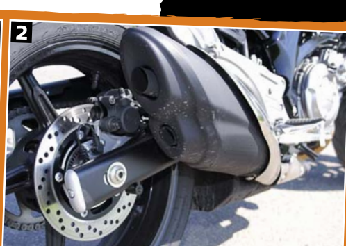
1. Przednie dwie tarcze o średnicy 290 mm nie gwarantują sukcesu. Hamulce są takie sobie. 2. Żeby było taniej: stalowy wahacz i malowany na czarno tłumik. 3. Najmocniejszy argument: znakomity, mimo że niezbyt mocny twin.
