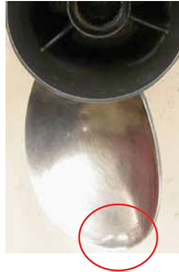
LTIH-316L Prop (60 min) Fin perforation
