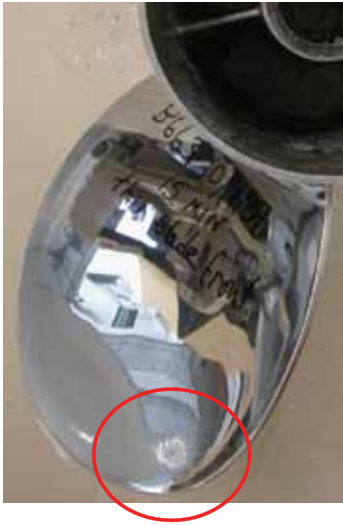
316L Prop (15 min) Fin perforation
