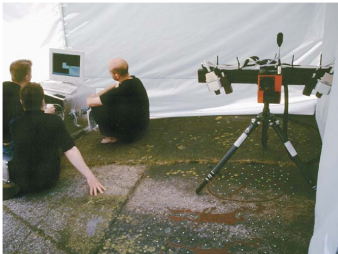
Stereoskanning i tält av hällristningen i Fossum, Tanum. På dataskärmen kontrolleras direkt på platsen att registreringen lyckats. Foto: Runo Löfvendahl.
