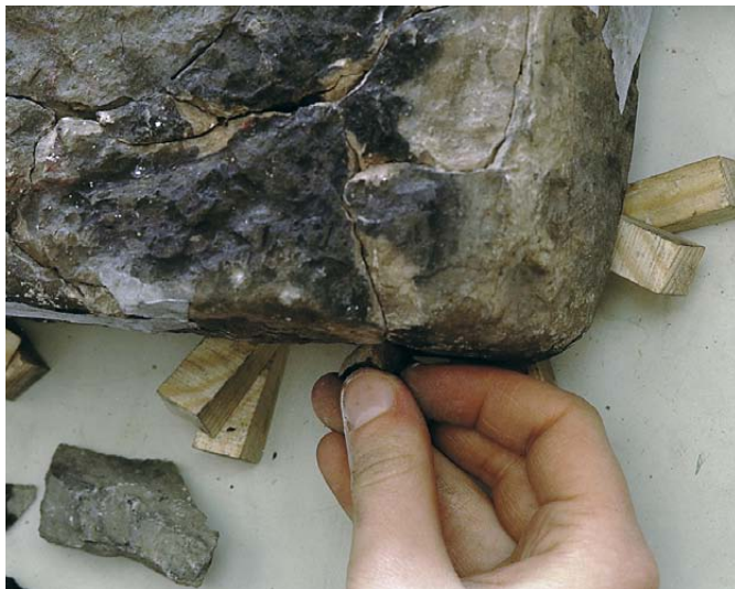
Ett exempel på konservering är konsolidering av en sten med vittringsskador. Foto: Bengt A. Lundberg.
