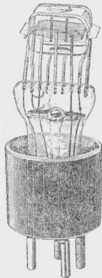
Рис. 209. Лампа УБ-110 с разбитым стеклянным баллоном.
