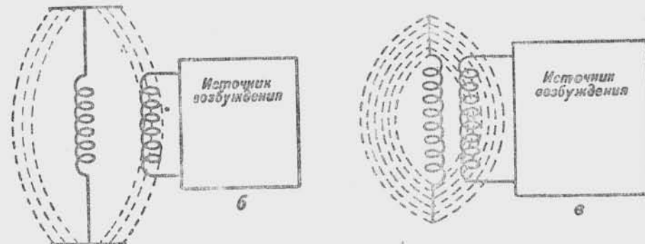
Рис. 171. Преобразование замкнутого контура в открытый колебательный контур.
