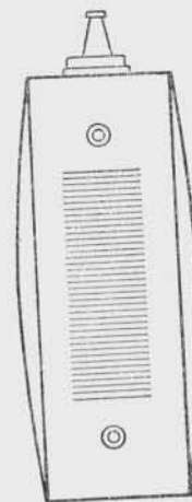
Рис. 128. Раздутие банки аккумулятора.
