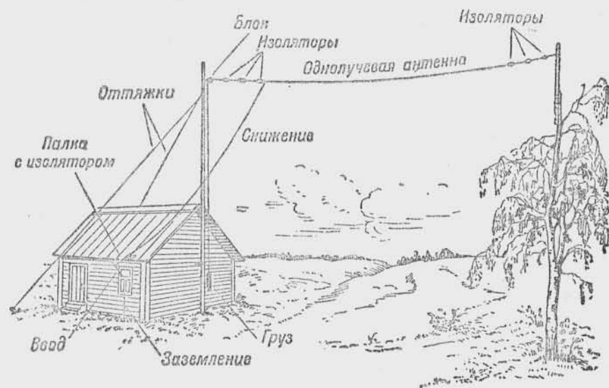
Рис. 180. Общий вид устройства приемной антенны.
