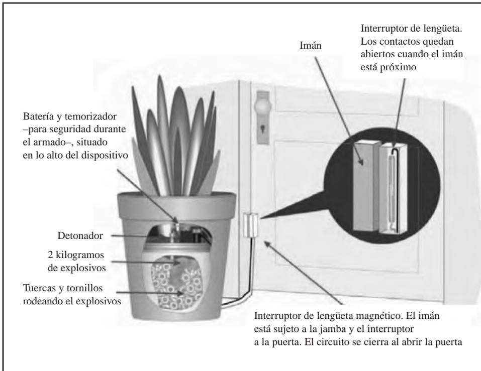
**Figura 10.**– IED accionado por la víctima. (Adaptado de AC/259-D(2004)0037 NIAG-D(04)09, volumen III, OTAN).
