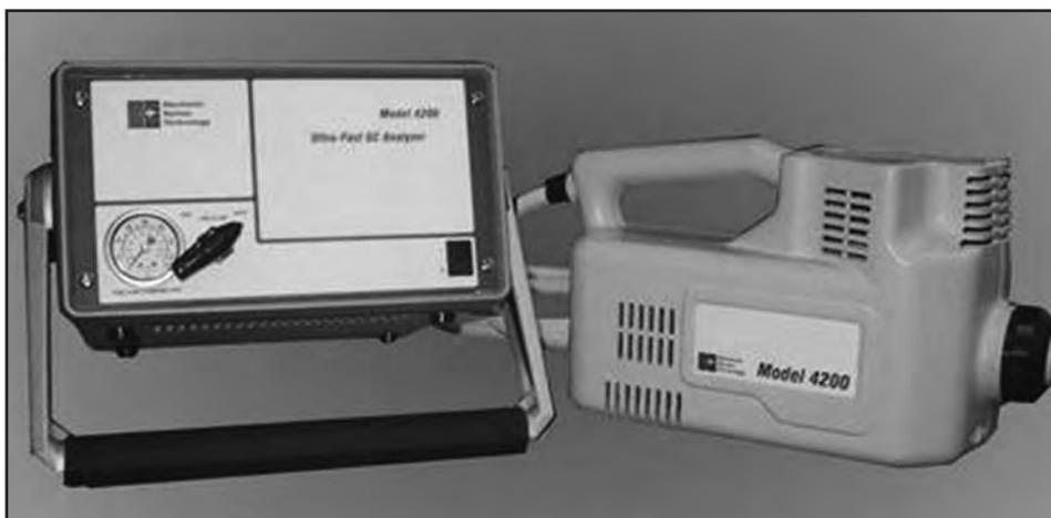
**Figura 19.**– Sistema de detección EST-4200 Ultimate Vapor Tracer & Analyzer, de Electronic Sensor Technology que utiliza un cromatógrafo de gases de alta temperatura con detector SAW.
