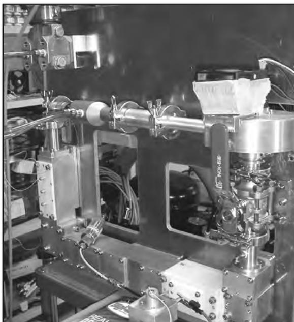
**Figura 15.**– *Equipo DMA para la detección de explosivos. Cortesía de Ramem.*
