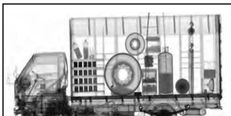
**Figura 29.**– Sistema *Dual-Energy Container/Vehicle Inspection Technology*, de *NUCTECH*, que permite distinguir los materiales en base a su número atómico, mostrándolos en diferentes colores.
