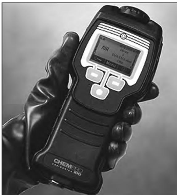
**Figura 14.**– *Detector portátil por IMS ChemPro100i de Environics.*
