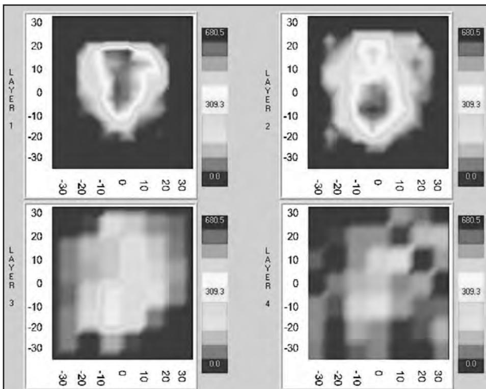
**Figura 26.**– Empleo de neutrones para detectar explosivos enterrados (Imagen de análisis de detección de explosivos enterrados). Cortesía de EADS.
