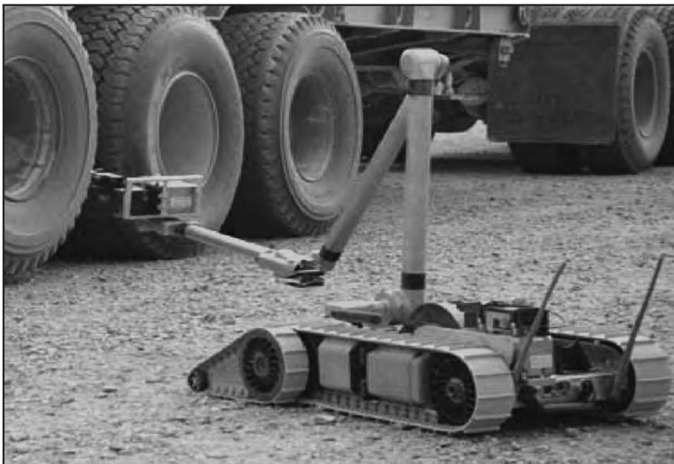
**Figura 21.**– *Detector por quimioluminiscencia Fido® OnBoard de ICx Technologies, Inc., montado en un robot.*
