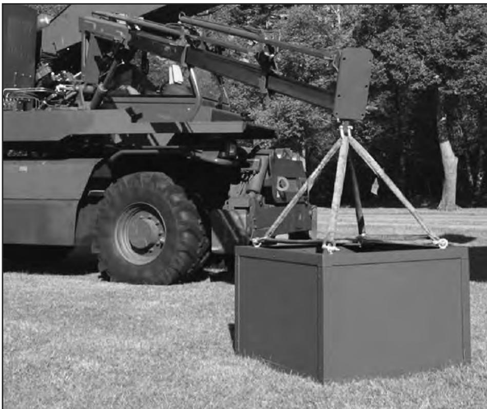
**Figura 25.**– Sensor desplegado sobre el terreno en aplicaciones de detección de minas por detección empleando neutrones. Cortesía de EADS.
