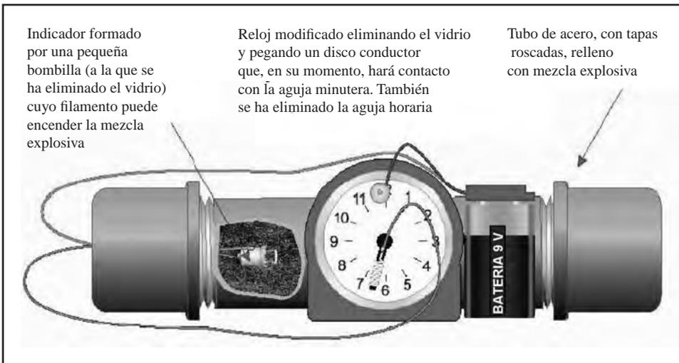
**Figura 9.**— *IED temporizado. (Adaptado de AC/259-D(2004)0037 NIAG-D(04)09, volumen III, OTAN).*
