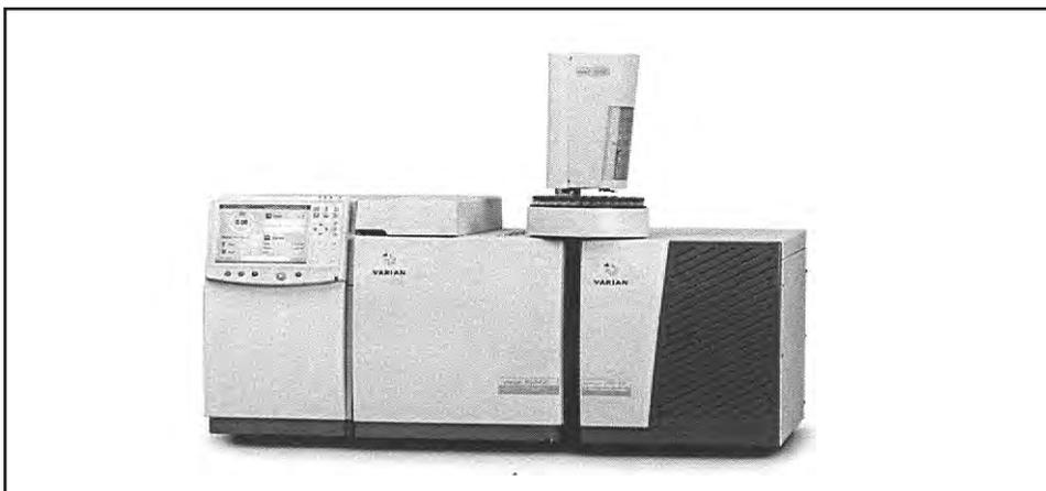
**Figura 17.**– *Sistema Varian 240-MS IONTRAP GC/MS de Varian, Inc., que combina el cromatógrafo Varian 450-GC con un espectrómetro de masas.*
