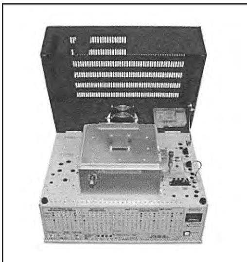
**Figura 18.**– *Cromatógrafo de gases SRI Explosives GC System, de SRI Instruments.*
