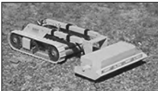
**Figura 36.**– *Equipo para localización de minas que combina radar y detector de meta les montado en vehículo para operación remota (PackBot), de CyTerra.*
