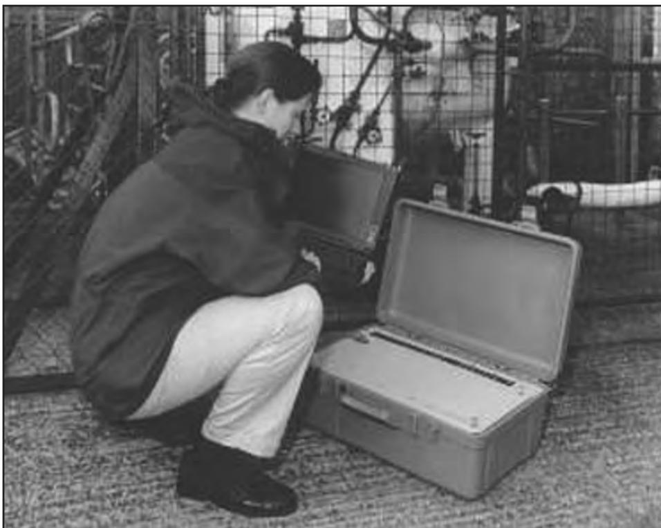
**Figura 16.**– Espectrómetro de masas portátil, con tecnología TOF, MS-200 de Kore Technology.
