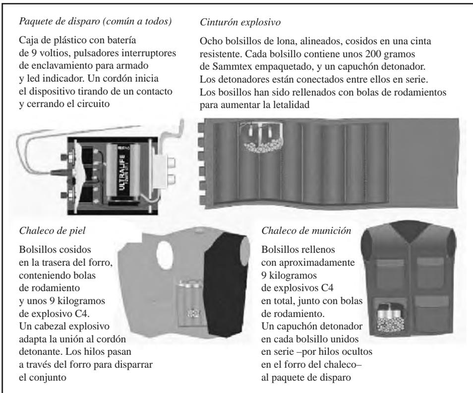
**Figura 12.**– Prendas de un IED suicida. (Adaptado de AC/259-D(2004)0037 NIAG-D(04)09, volumen III, OTAN).
