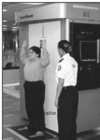
**Figura 28.**– *Sistema SECURE 1000 de Spectrum San Diego, Inc., que utiliza rayos X retrodispersados.*
