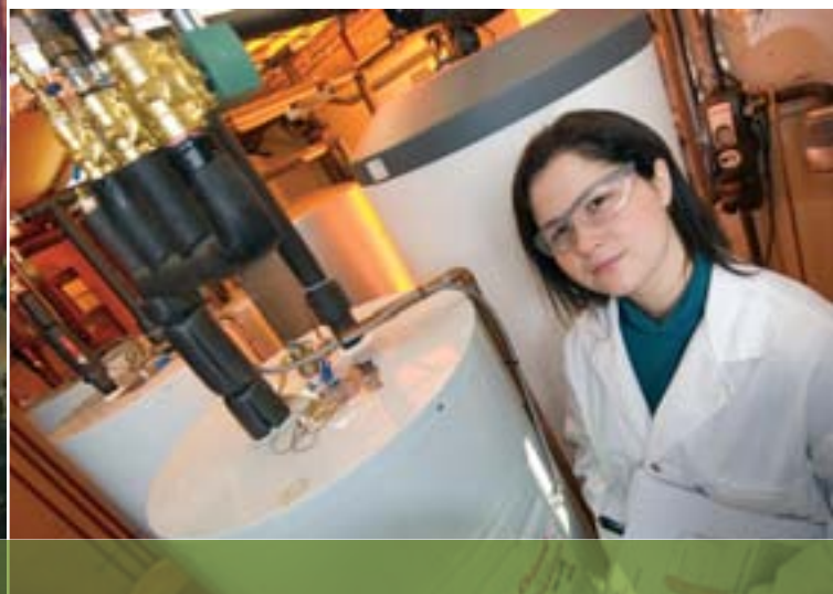
Nouveau modèle de chauffe-eau solaire à l'essai dans notre Laboratoire des technologies de l'énergie.
