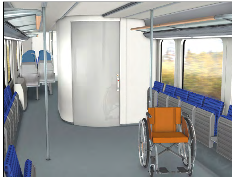
Mehrzweckabteil mit behindertengerechter Toilette
