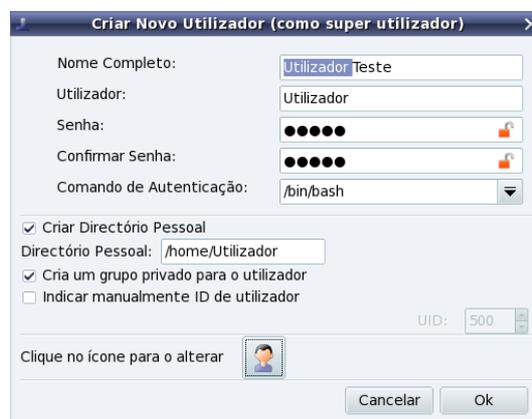
Figura 4.4: Adicionar utilizador
