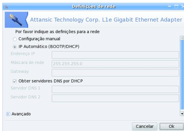
Figura 9.15: Configurar interface de rede
