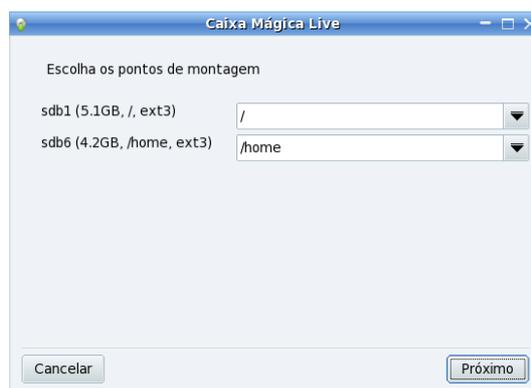
Figura 3.32: Live CD – pontos de montagem das partições
