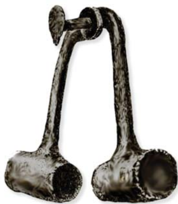
Такие сопряженные штемпели в виде щипцов применялись для чеканки монет в Древнем Риме.
