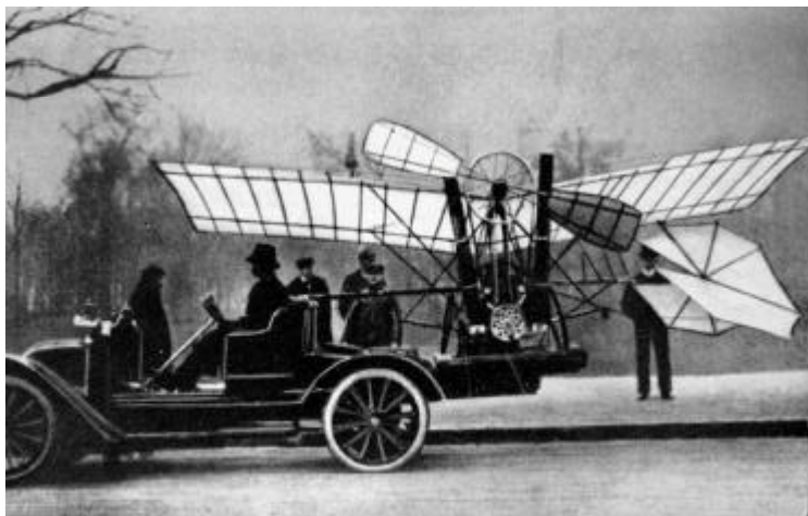
Le Santos-Dumont n° 19bis à moteur V8 Antoinette de 24 ch avant un vol à Saint-Cyr le 16 novembre 1908.
