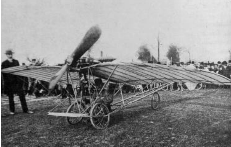
Le Santos-Dumont n° 20 à moteur Dutheil et Chalmers de 25 ch, mars 1909.
