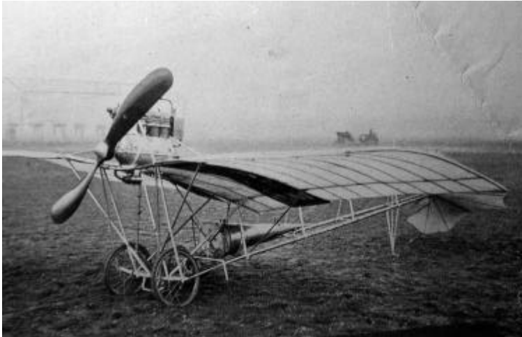
Le Santos-Dumont n° 20 à moteur Clément-Bayard (Clerget) 4-cyl de 50 ch, janvier 1909.
