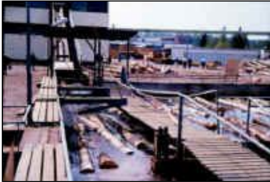
Abb. 3: Wasserlagerung des Birkenholzes macht eine weitere Vorbehandlung (Dämpfen) vor dem Schälen überflüssig, Firma Isku in Lathi/Finnland [Foto: U. LOHMANN]
