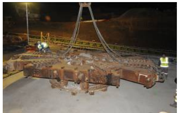
Arrivée de la roue de coupe (9,15 m de diamètre, 100 tonnes)
