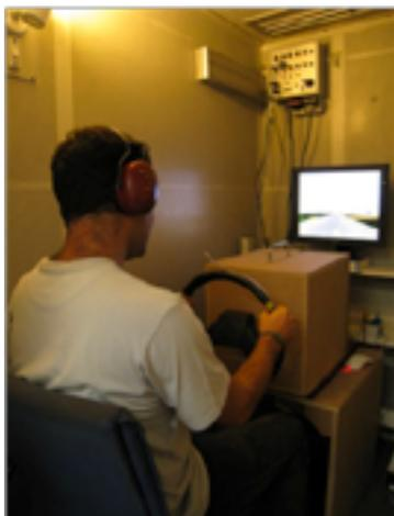
*Figure 3 - Dispositif expérimental pour l'étude d'alarmes audio tactiles dans le cadre du projet ANR Roadsense.*
