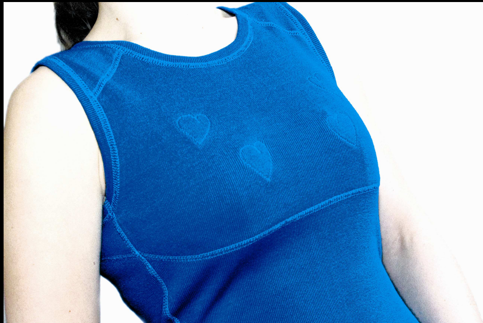
EKG mérés trikóba beépített szenzorral
