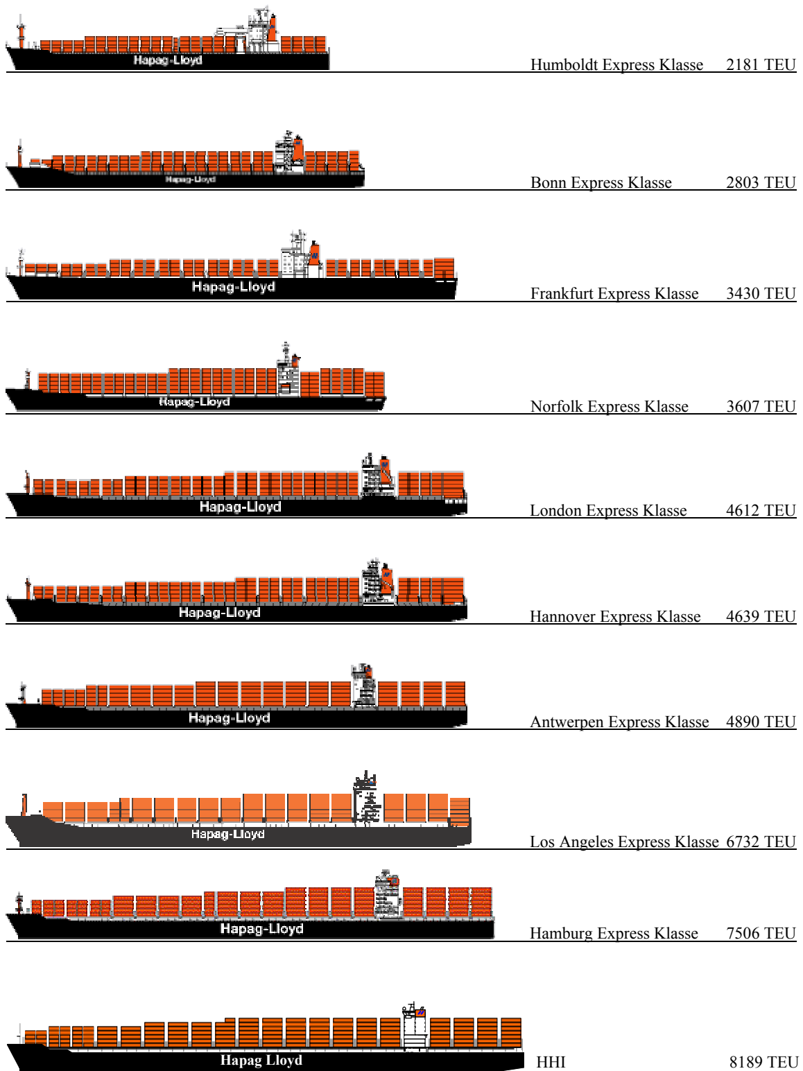
Darst. 7: Grafische Darstellung des Entwicklungsprozesses der Containerschiffsgrößen
