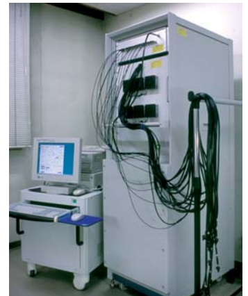
写真2 16チャンネル時間分解計測システム (光断層イメージングシステム)
