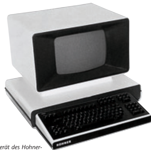
Bildschirmgerät des Hohner-Magnetplattencomputers HC 1
