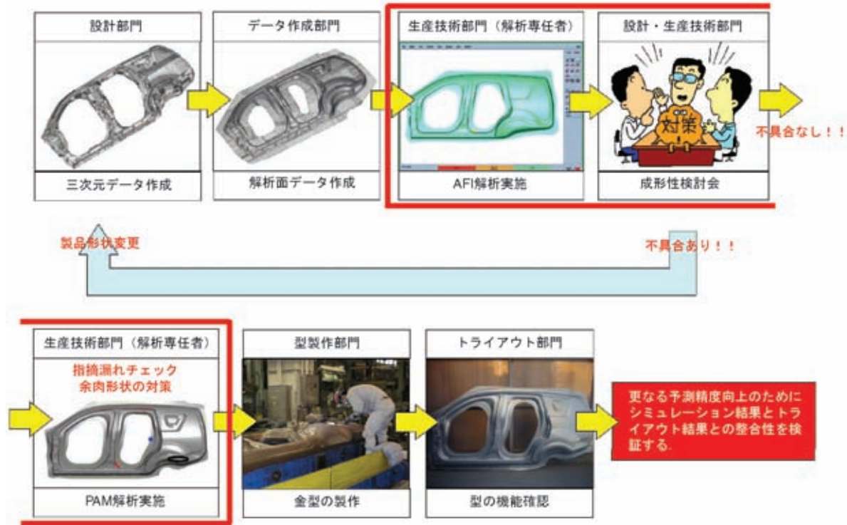
図3 解析業務の流れ Stamping simulation workflow
