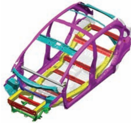
図4 「i」のボデー骨格 Body structure of "i"
