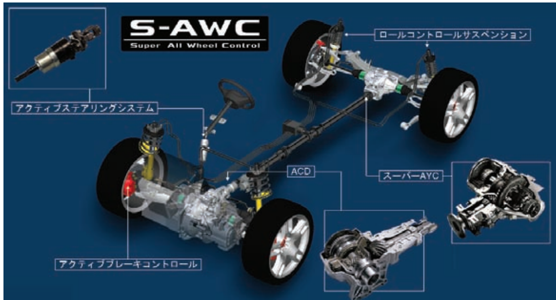
図3 S-AWCシステム構成例 S-AWC system configuration
