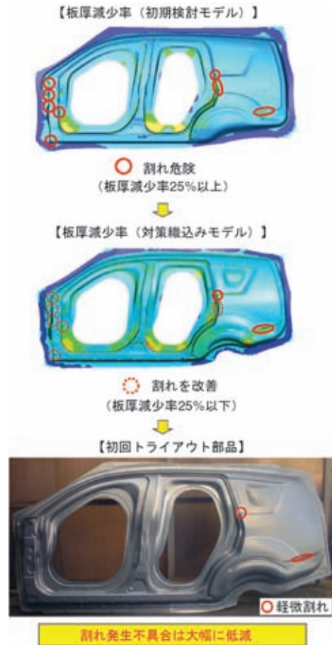
図5 アウトランダーのサイドパネルアウターにおける不具合低減効果 Defect-reducing effect on side panel outer of OUTLANDER
