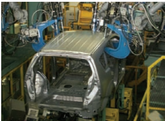
図 17 アウトランダー メインライン内での SPR 接合状況 SPR joining along OUTLANDER main line
