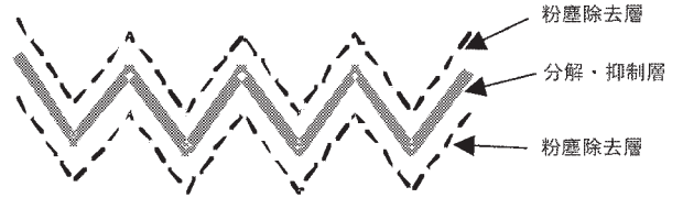
図5 フィルター用濾材の構造 Composition of filter media
