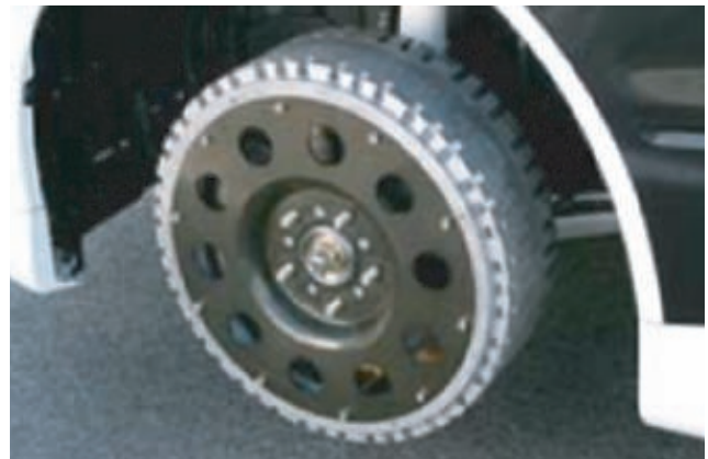
(b) ランサーエボリューションMIEV用アウト ローター型インホイールモーター
