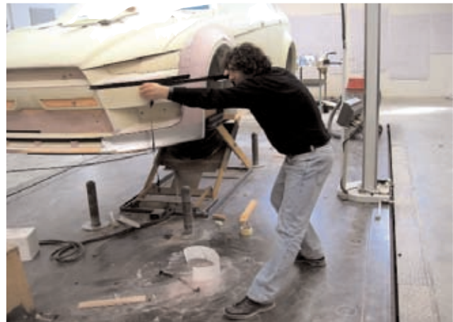
1/1 モデルでリファイン検討中のハリルホジッチ氏 Mr. Halilhodzic working on the 1/1 exterior model
