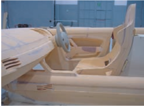
作業途中の樹脂製 1/1 インテリアモデル 1/1 interior model under development
