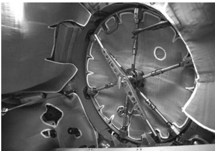
Осваиваюсь в корабле. Прямо над пультом расположен люк перехода из спускаемого аппарата в бытовую отсек. В 2007 году такой люк спас экипаж Котова – Юрчихина – Шейха Мусафара Шукора, а в 2008-м сохранил жизни Маленченко – Уитсон – Ли Со Ён
