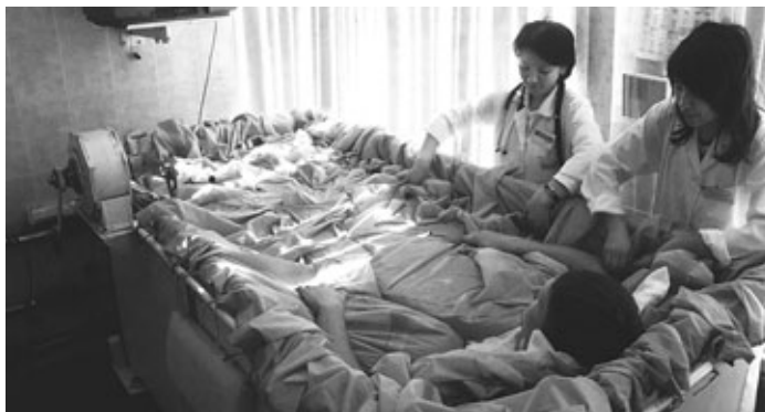
Сухая иммерсия – это способ моделирования факторов невесомости. В ванну с водой погружают испытателя, которого от жидкости отделяет водонепроницаемая пленка. Человек в течение эксперимента находится как бы в подвешенном состоянии. В организме происходит перераспределение жидкости, ликвидируется опора и снимается весовая нагрузка с тела. Фото ИМБП
