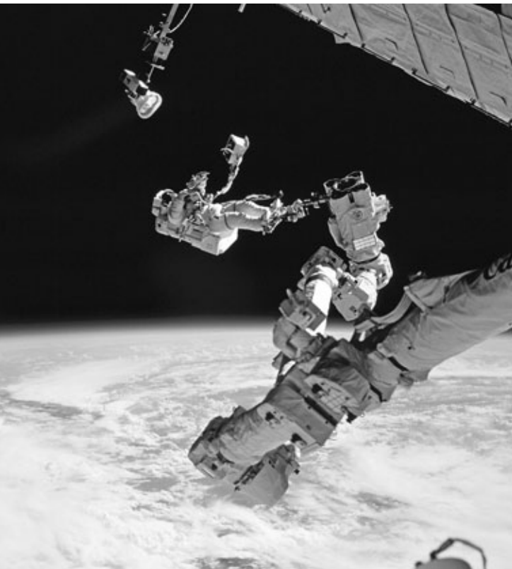
С помощью манипулятора SSRMS астронавты доставляют в удаленные места на поверхности МКС. Октябрь 2002 года, астронавт Дэвид Вульф. Фото НАСА
