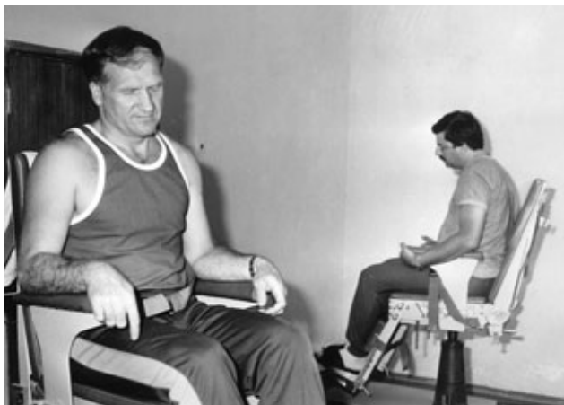
Космонавты Виктор Афанасьев и Муса Манаров на вестибулярной тренировке. Во время вращения испытуемые медленно наклоняют голову поочередно к левому и правому плечу. Этим создается ощущение сложного качания
