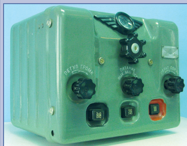
Радиоприемник УС-3С. Коротковолновый связной приемник, устанавливался на самолеты, входил в состав радиостанции РАФ. Выпускался в годы Великой Отечественной войны.
