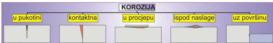
**Korozijsko oštećenje** – gubitak funkcije metalnog dijela/sustava izazvan korozijom.
