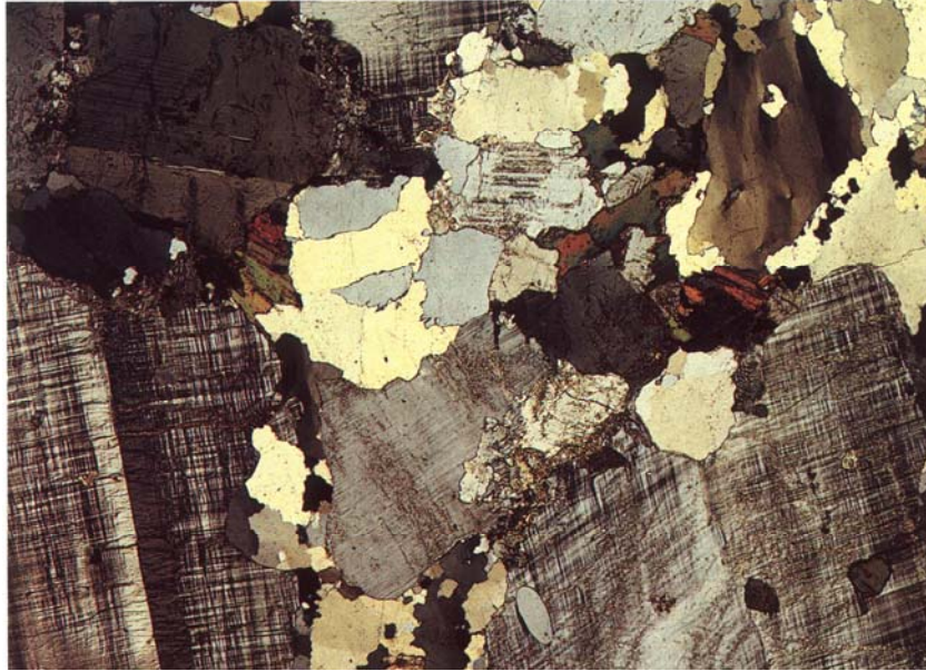
Сл.1. Микроскопска фотографија на гранит + Н
