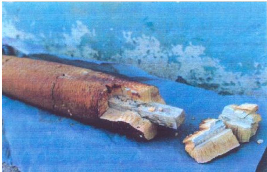
شكل رقم ١٠ : أثر الترسبات يفسر أهمية المعالجات الأولية للمياه قبل دخولها غرف التحلية
