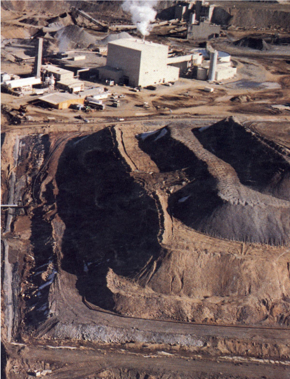
Φωτ. 1.2: Εκχύλιση χρυσού σε σωρούς απορριμμάτων από τη εταιρεία FMC, Paradise Peak, Nevada, USA.
