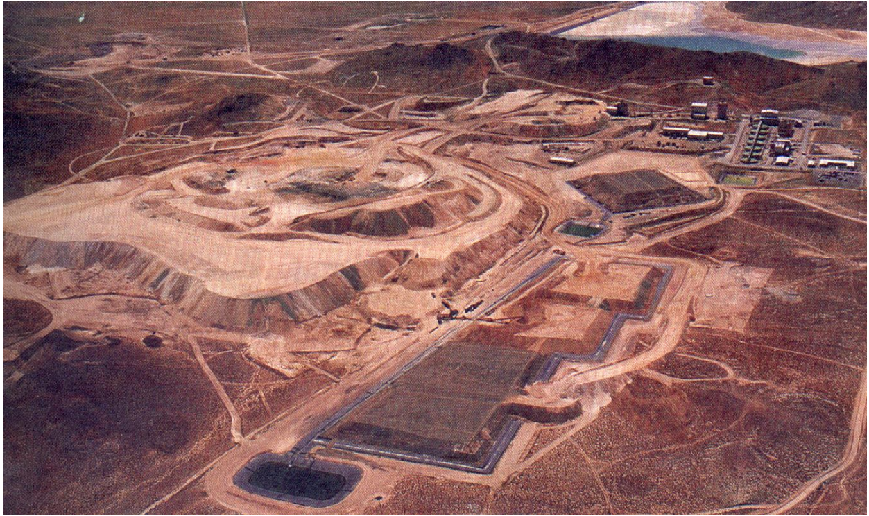
Φωτ. 1.1: Εκχύλιση χρυσού σε σωρούς από την Εταιρεία FMC, Paradise Peak, Nevada, USA.
