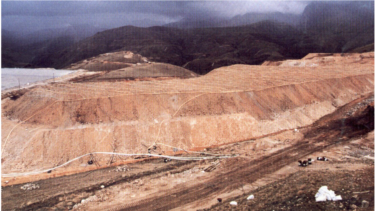
Φωτ. 1.4: Εκχύλιση χρυσού σε σωρούς πολλαπλών βαθμίδων στο Περού από την Εταιρεία Comarsa
