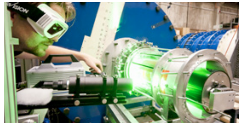
Abb. 4 Dipl.-Ing. Robert Sorge während einer Geschwindigkeitsmessung mittels High Speed Partikel Image Velocimetrie (HSPIV)
