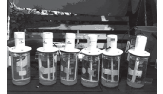
Kuvassa dekanterit, joissa vesinäytteet eri kemikaalipitoisuuksilla koagulaatiovaiheen jälkeen. Kuvasta huomaa, kuinka epäpuhtaudet ovat laskeutuneet dekanterien pohjalle ja pinnalla on vain puhdas vesi. Ennen kemikaalilisäyksiä ja puhdistusta kaikki näytteet olivat ruskeankeltaisia ja sameita.
