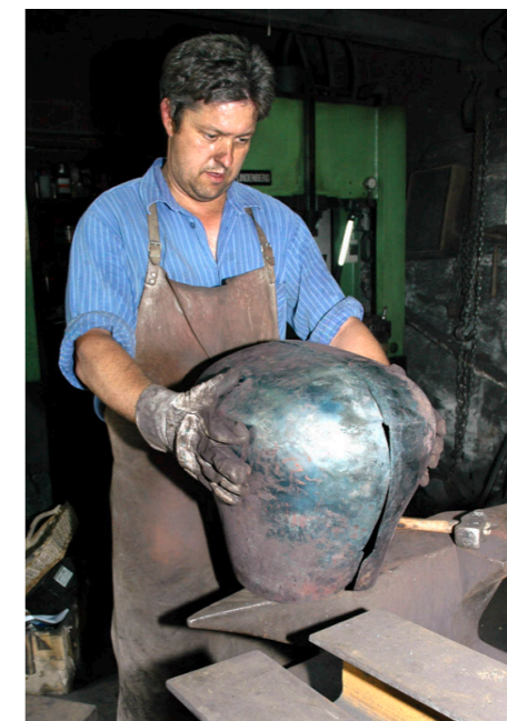
Passen die Hälften zueinander, werden sie genietet und zusammengeschweisst.
