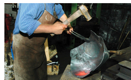
Es ist schmiedbar bis 800 °C, solange es noch dunkelrot glüht.
