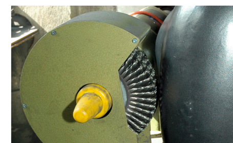
Ihren Glanz erhält die Treichel durch das Polieren mit der Drahtbürste.
