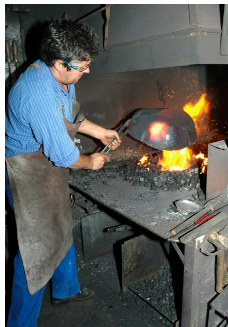
In der Esse erreicht das Stahlblech eine Temperatur von 1000 bis 1200 °C.
