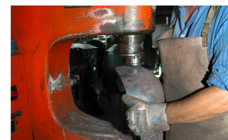
Im Kraftformer werden letzte Unebenheiten ausgeglichen.
