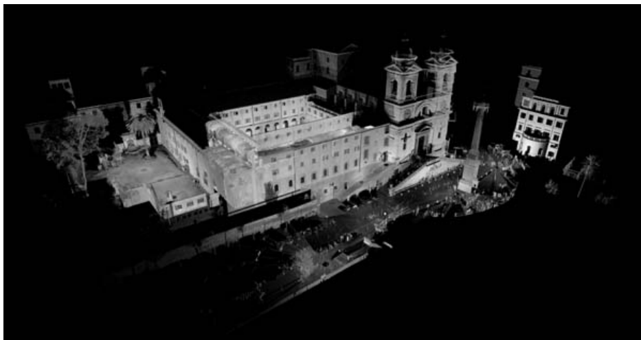
Figura 1. Nuvola di punti da scansione laser del complesso Conventuale di Trinità dei Monti, Roma.
