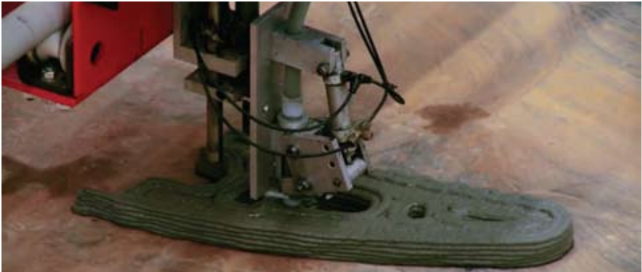
הזרוע הרובוטית של מכונת הדפסת הבטון היוצקת שכבות דקות של בטון זו על גבי זו כדי ליצור את התבנית המבוקשת של רכיב הבטון
