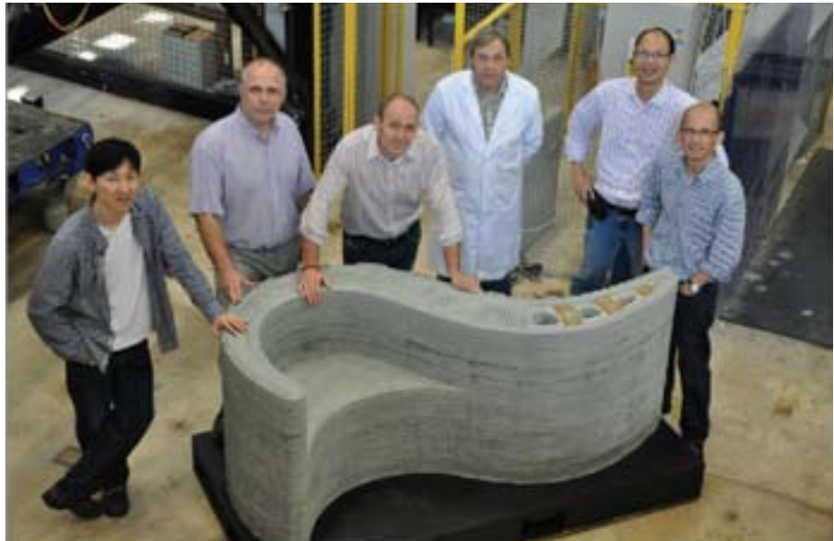
"ספסל הפלא" שהודפס בבטון כבר בשנת 2010 עם צוות המחקר של אוניברסיטת לאפורו הבריטית, שמפתח את הדפסת הבטון. בחלקו הימני של הספסל נראים החללים שהושארו בו בהדפסה להשחלת צינורות וקווי תקשורת וחשמל בתוכם. הראשון משמאל הוא ד"ר לים הדרום קוריאני, העומד בראש הצוות
