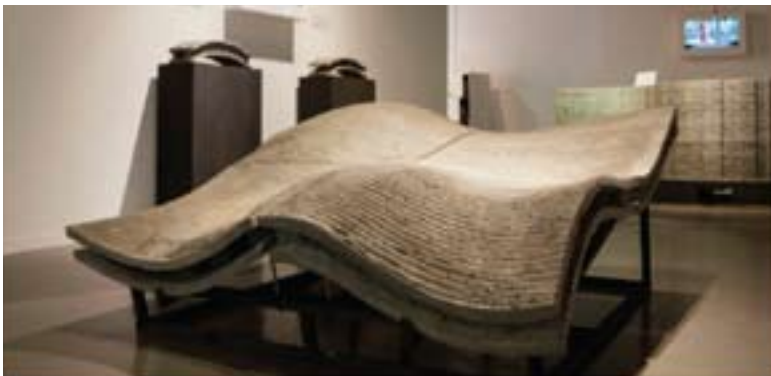
לוח בטון דו-שכבתי מודפס שהוצג בתערוכת בנייה שנערכה בבריטניה בשנת 2011. אין שום יציקת בטון המשתווה לעיקולים שהצליחה הדפסת הבטון ליצור בלוח זה
