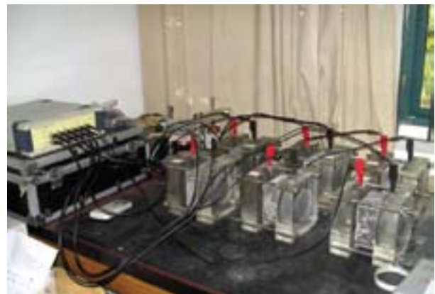
צילום 1. המתקן לבדיקות חדירות יוני כלוריד לפי תקן ASTM C 1202
