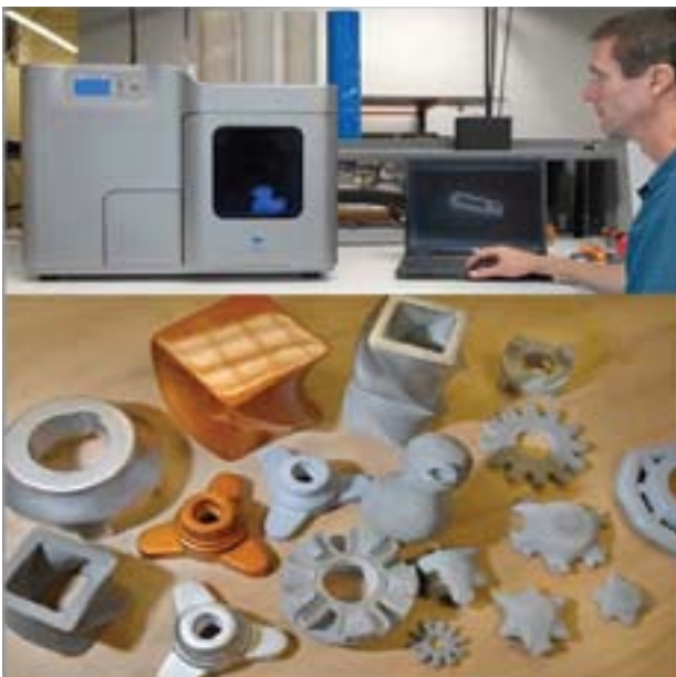
מכונת דפוס המדפיסה מוצרים מחומרים פלסטיים. מכונת מסוגה קיימות בשוק מזה עשר שנים וכנסו לשימוש תעשייתי נרחב
