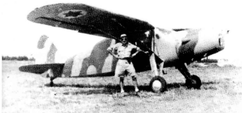
פיירצ'יילד F-24 ארוס - מטוס אמריקני מתקדם יחסית ל"אוסטר", בעל מנוע חזק וחמישה מקומות ישיבה. במטוס כזה אפשר לקחת פצצות במשקל של שלושה אנשים, כ-300 קילוגרם. שימש תקופה קצרה לטיסות הפצצה עד שניזוק בהמראה ביבנאל. בתמונה - הפיירצ'יילד המצרי בשדה דב.
