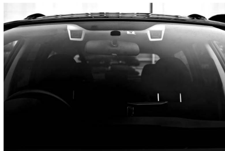
フロントガラス上部に見えるのが、新型ステレオカメラと新開発3D画像処理エンジンによってブリククラッシュセーフティ(衝突被害軽減)を実現した「EyeSight」のユニット。
