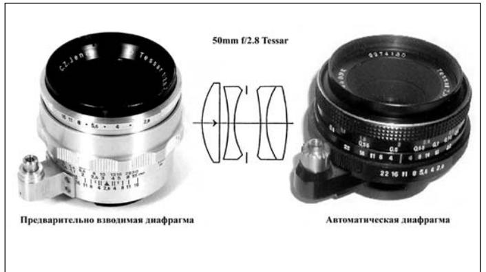
Рис.6: 50mm f/2.8 Tessar CZJ с механизмом предварительного взвода диафрагмы и 50mm f/2.8 Tessar CZJ с автоматической диафрагмой.
