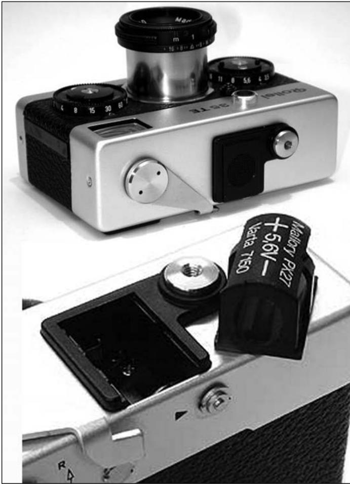
Рис.20: Батарейная ниша на Rollei 35 TE.
