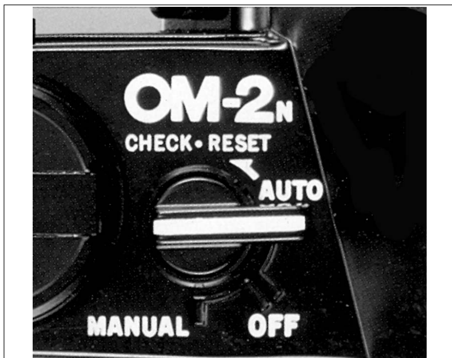
Рис. 10: Переключатель режимов экспонирования "MANUAL" - "OFF" - "AUTO" - "CHECK - RESET" для OM-2n
