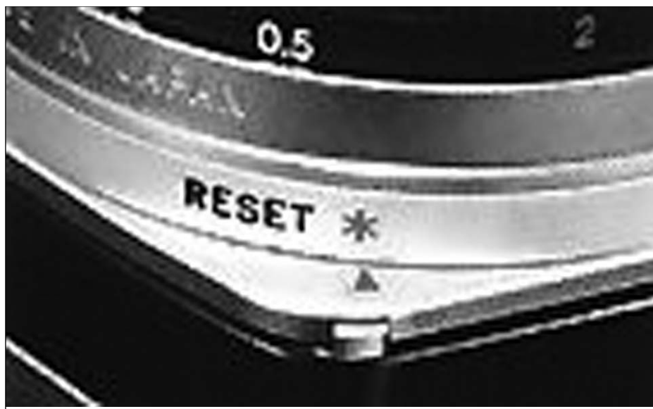
Рис. 11: Красная метка "RESET *" на диске переключения скоростей затвора OM-2
