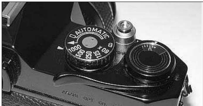
При установке головки выдержки в положение Automatic с квадратиком - окошко видоискателя закрывается светонепроницаемыми шторками.
