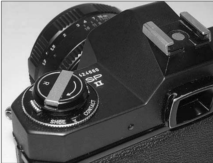
Разъём для бескабельного подключения фотовспышки с центральным контактом камеры Asahi Pentax SP II и диск переключения типа синхронизации.
