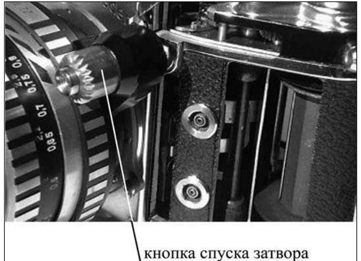
Рис.4: Все полуавтоматические и автоматические объективы для Экзакты имеют кнопку, которая при монтаже объектива сопрягается с кнопкой спуска затвора камеры.
