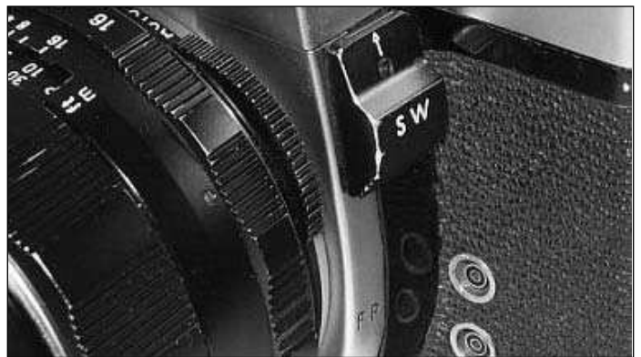
Кнопка выключателя экспонометра, она-же кнопка просмотра глубины резкости. Под белой стрелочкой окошко индикации включения экспонометрии.
