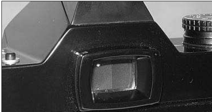
При установке головки выдержки в положение Automatic с квадратиком - окошко видоискателя закрывается светонепроницаемыми шторками.
