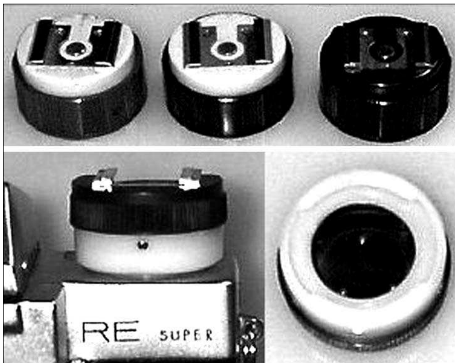
Рис.16: Всевозможные адаптеры для монтажа необходимых аксессуаров, на установочном кольце, окружающем рулетку обратной перемотки
