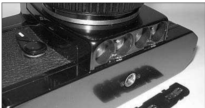
Батарейный отсек Asahi Pentax ESII. В нижней части основания крепления объектива-четыре элемента SR-44
