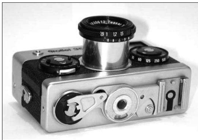
Рис.3: Перед съёмкой объектив необходимо выдвинуть из корпуса аппарата.
