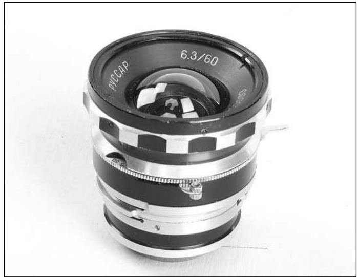
Легендарный широкоугольный объектив "Руссар", 6,3/60 мм, № 000002. Предполагалось использовать его в качестве сменного широкоугольника.
