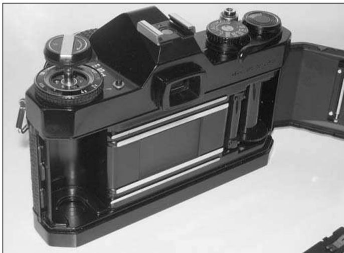
Asahi Pentax ESII - аппарат имеет затвор с очень плотными прорезиненными матерчатыми шторками.
