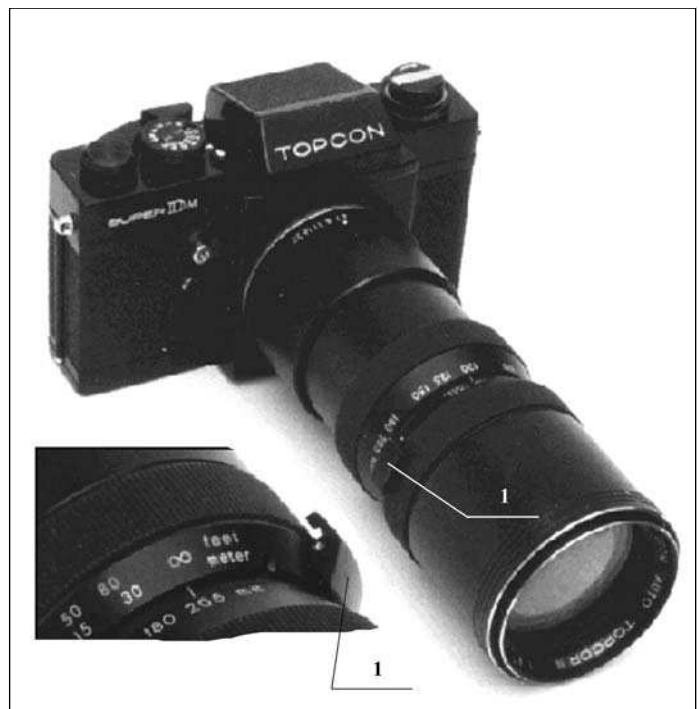
Рис.9: Topcon Super Dm со стандартной пентапризмой (не "СС"), используемый для авиации ВМФ США (1- замок фиксации фокуса в "бесконечности")
