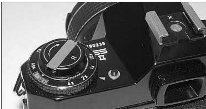
Установка чувствительности плёнки, экспокоррекция и памятка - всё на диске под рулеткой обратной перемотки.
