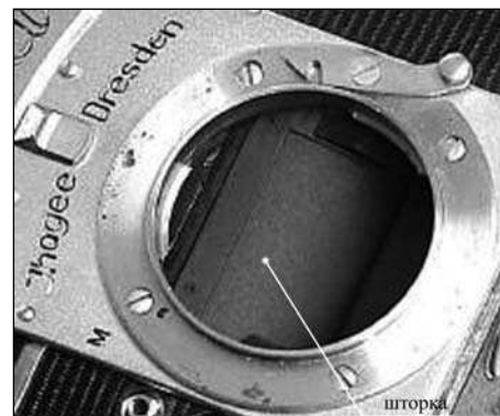
Рис. 4: Шторка секторного затвора.
