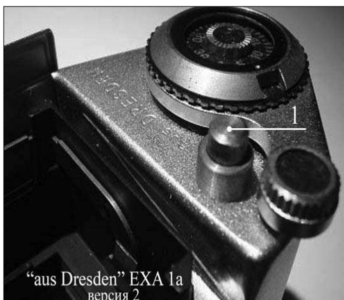
Рис. 18: EXA 1a, версия 2, с гравировкой "aus DRESDEN". (Поз1 - кнопка разрешения обратной перемотки).
