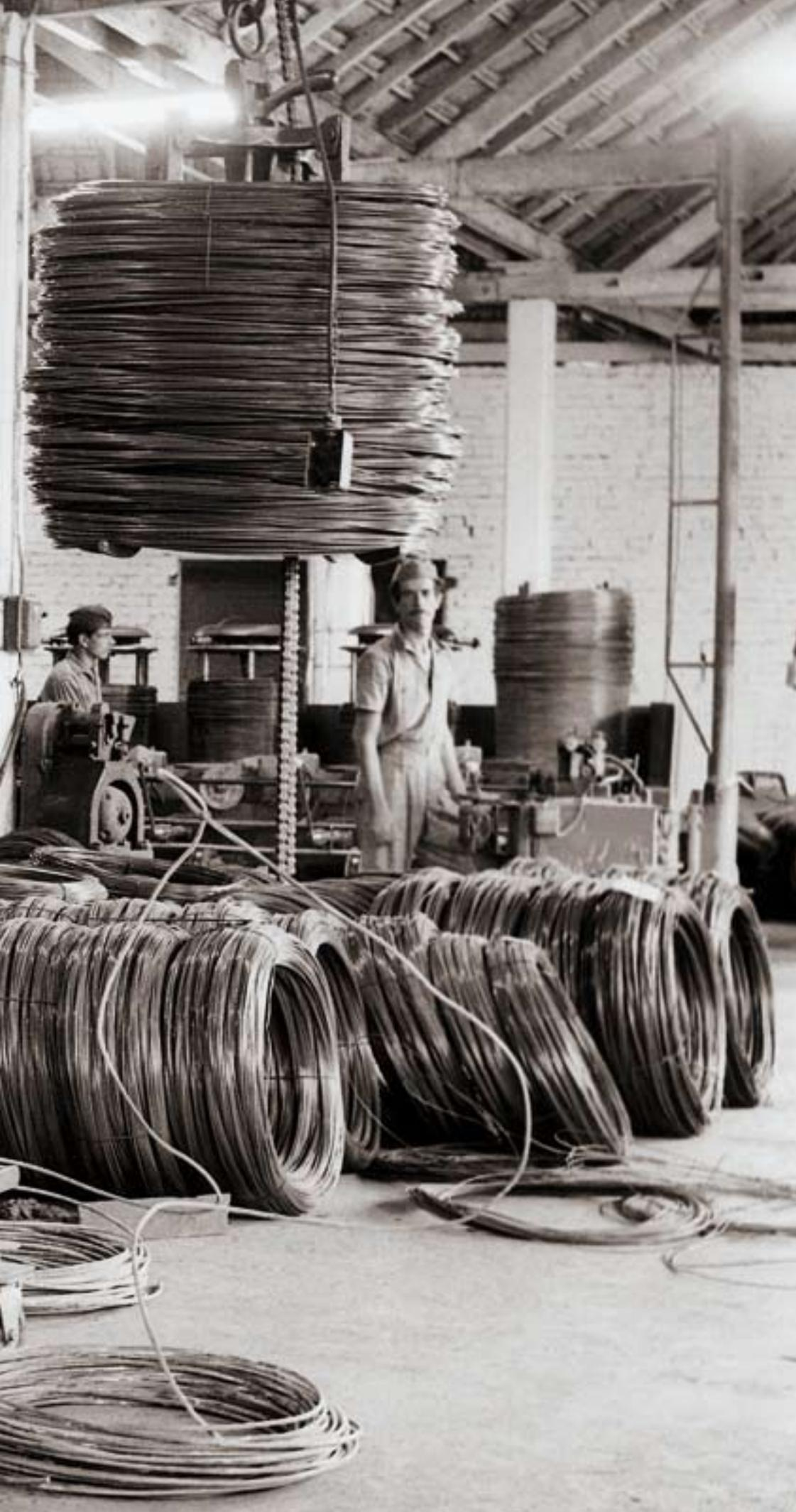
A trefilaria nos anos 1950. Logo após a aquisição da Riograndense pela Gerdau, a siderúrgica recebeu várias melhorias técnicas e de infraestrutura, com a importação de novas máquinas e a implantação da trefilaria.
