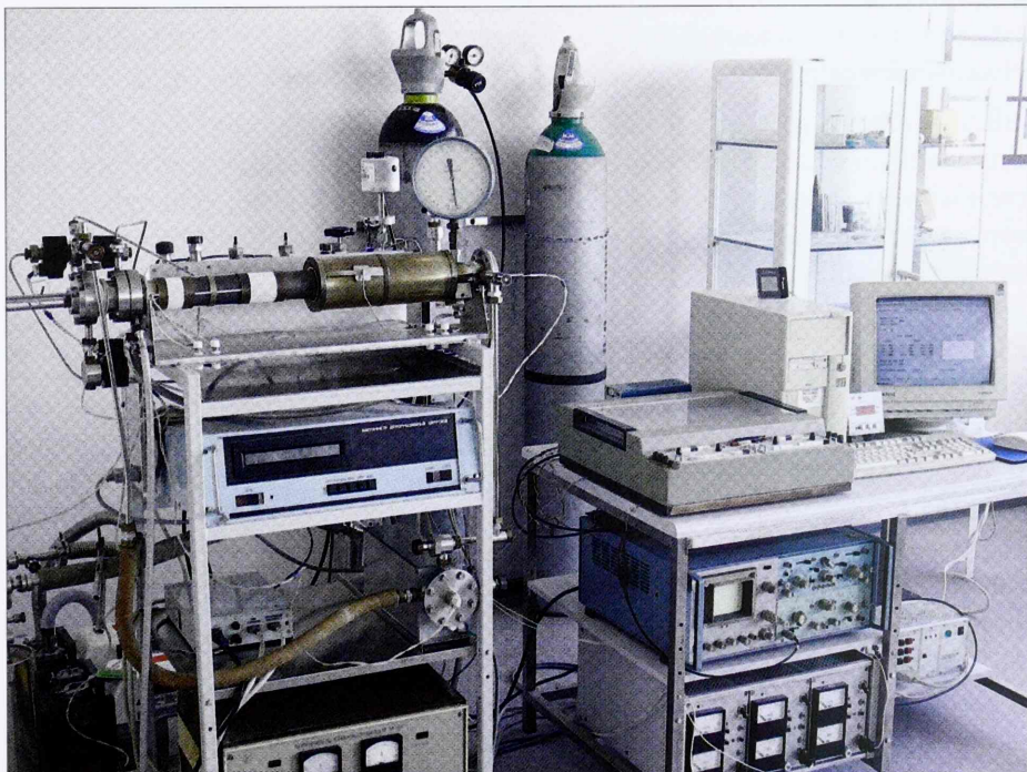
Foto 2. Dielektriliste materjalide aatomkihtsadestamiseks kasutatud Tartu Ülikoolis konstrueeritud seade.
