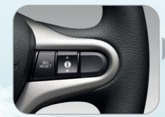
สวิตช์ควบคุมระบบหน้าจอแสดงผลข้อมูลบนพวงมาลัย
