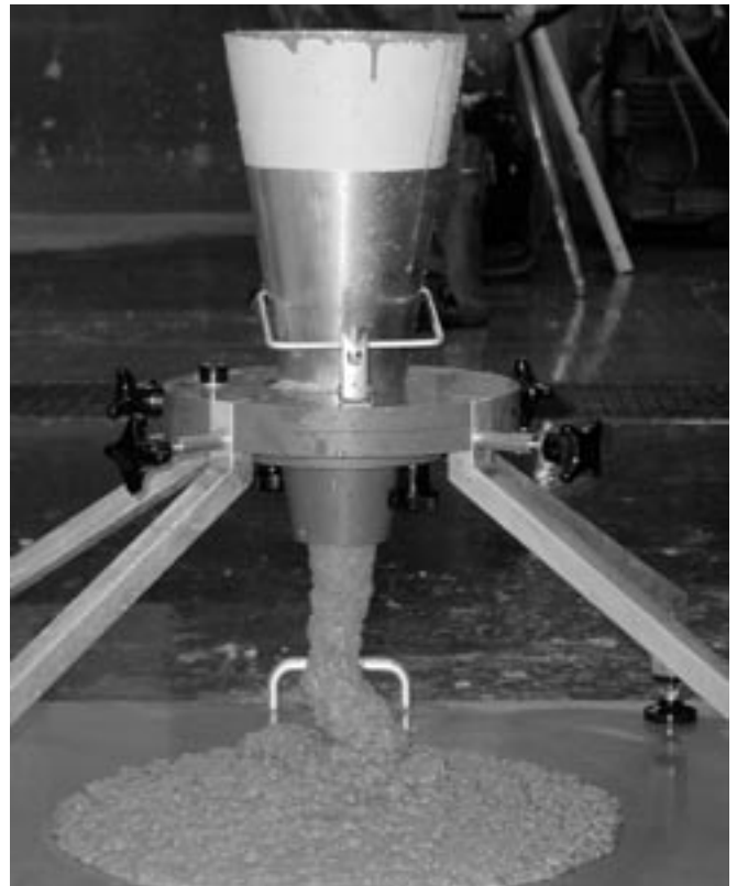
Bild V-30: Ermittlung der Auslaufzeit und des Setzfließmaßes mit dem Auslaufkegel
