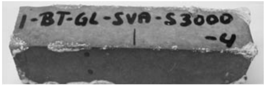
Bild V-24: Betonprüfkörper (w/z = 0,60) auf Basis von Portlandzement (CEM I 32,5 R) und Quarz-Kies nach 45 Monaten Lagerung in 0,44 %iger Natriumsulfatlösung bei 8 °C
