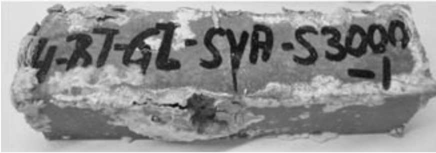
Bild V-25: Betonprüfkörper ( w/z = 0,60 ) auf Basis von Portlandzement (CEM I 32,5 R) und Kalksteinsplitt nach 45 Monaten Lagerung in 0,44 %iger Natriumsulfatlösung bei 8 °C
