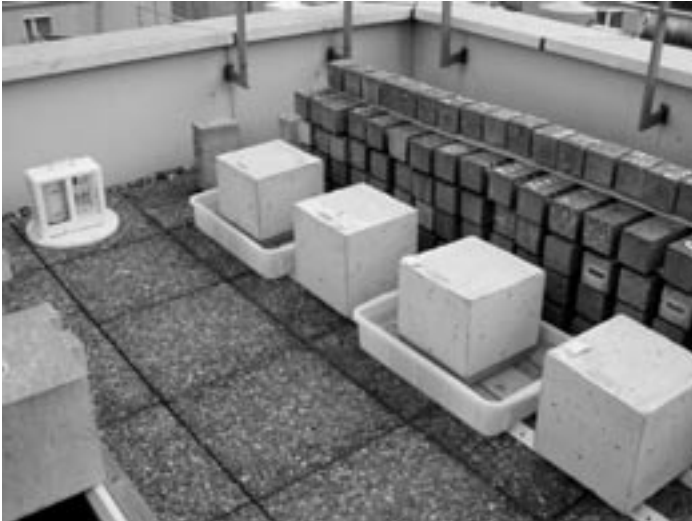
Bild V-18: Luft- und Fußbadlagerung von 30-cm-Würfeln im Freien
