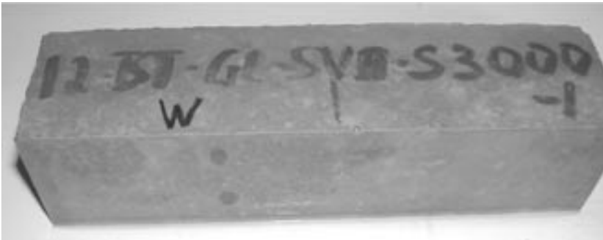
Bild V-26: Betonprüfkörper ( w/z = 0,60 ) auf Basis von HS-Zement (CEM III/B-HS) und Kalksteinsplitt nach 45 Monaten Lagerung in 0,44 %iger Natriumsulfatlösung bei 8 °C
