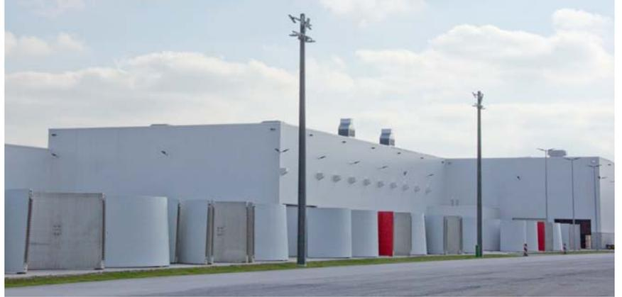
In einem zweiten Arbeitsgang wird anschließend an den vertikalen Außenflächen der Ringe ein spezielles farbiges Beschichtungssystem aufgebracht. Auf diese Weise können die fertigen Ringe bei der späteren Errichtung zum Betonturm „in trockener Fuge“, also ohne jegliche Mörtel- oder sonstige Ausgleichsschicht, einfach aufeinandergesetzt werden.
