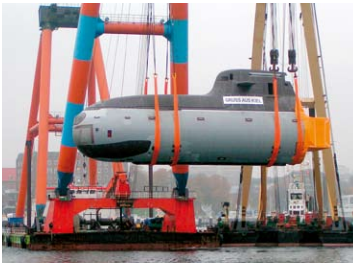
Dolezych -Rundsclingen sichern ein 6600-Tonnen-U-Boot-Segment.
